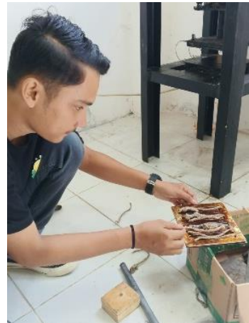
Hasil Ekstrusi Dimasukkan ke Cetakan Tarik untuk Di-press
