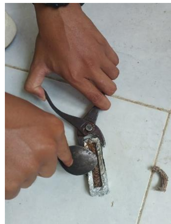
Hasil Ekstrusi Dimasukkan ke Cetakan Impak untuk Di-press
