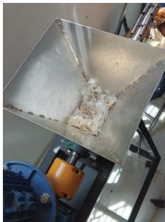
Campuran Bahan Dimasukkan ke dalam Mesin Ekstrusi
