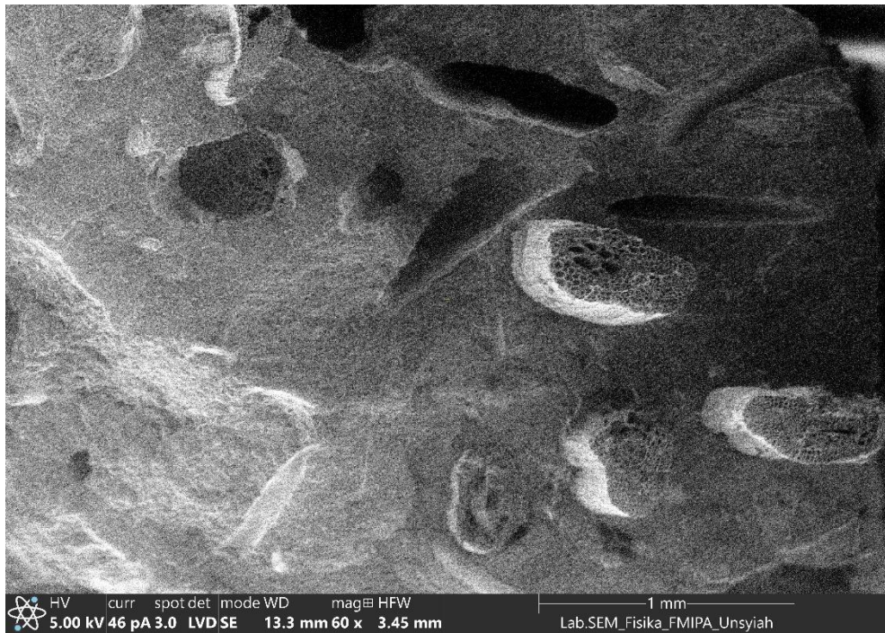
Permukaan Komposit 20%:80% dengan BPO 0,5% (Pembesaran 60×)
