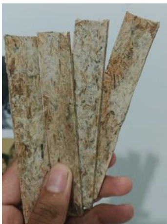
Komposit Serat Pelepah Pinang dan Polipropilena Setelah Di-press
