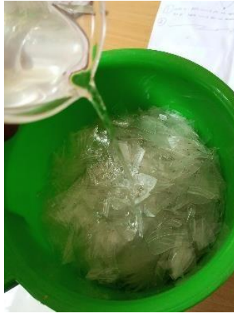
Pencampuran Polipropilena dengan Xilena dan BPO
