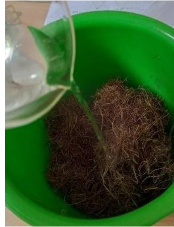
Pencampuran Serat Pelepah Pinang dengan Heksana dan MAH
