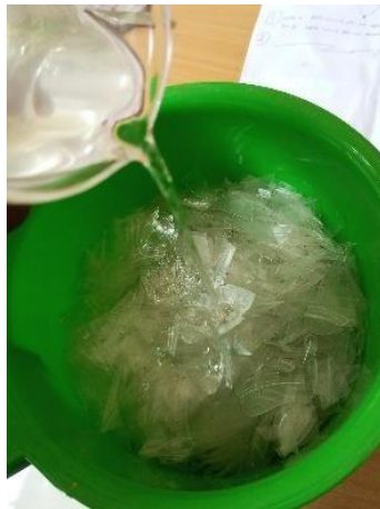
Pencampuran Polipropilena dengan Xilena dan BPO
