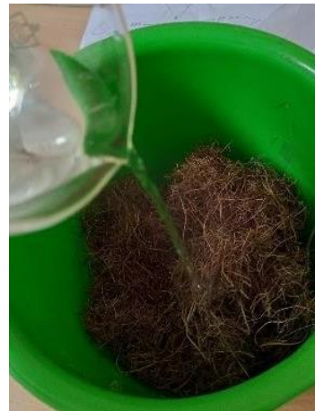
Pencampuran Serat Pelelah Pinang dengan Heksana dan MAH
