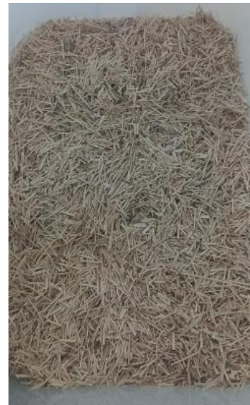
Serat Pelelah Pinang yang Dipotong dengan Ukuran 1 cm
