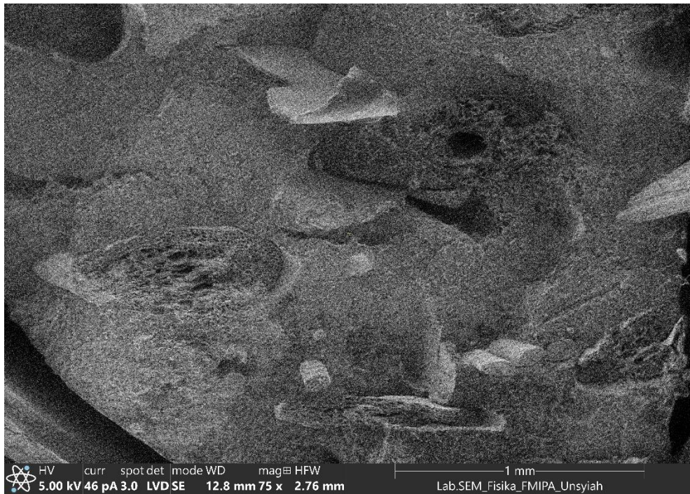
Permukaan Komposit 20%:80% dengan BPO 0,5% (Pembesaran 75×)
