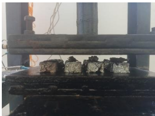
Cetakan Dimasukkan ke Mesin Hot Press Hidrolik
