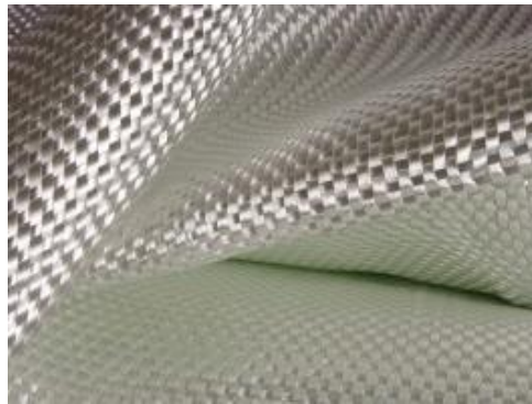
Gambar 2.3 Fiberglass dalam Bentuk Kain Sumber: www.ategroup.com
