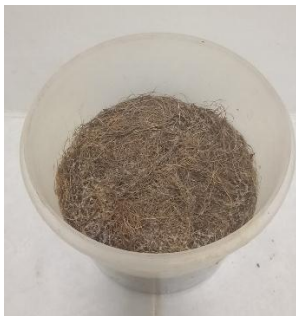
Gambar C.14 Perendaman TKKS dengan NaOH
