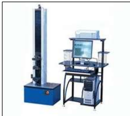
Gambar 2. 6 Alat Uji Tarik pada Plastik
