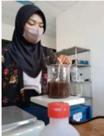
Gambar C.5.1 Pencampuran serbuk sabut kelapa sawit dengan NaOH
