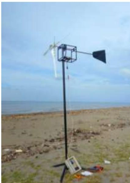
Gambar 4. 8 Bentuk fisik prototipe pembangkit listrik tenaga bayu
