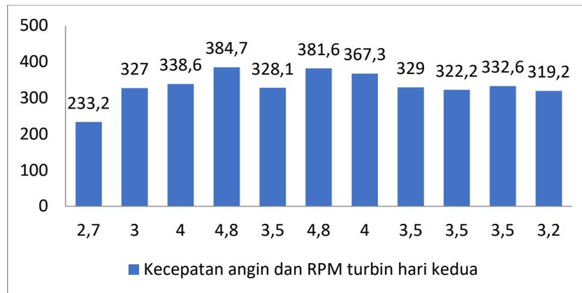
Gambar 4. 14 Laju angin dan RPM turbin
