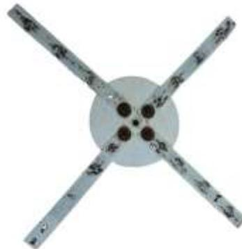
Gambar 4. 4 Plat hubung *blade*/baling-baling ke generator
