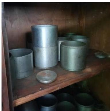
Gambar 3. 15 Cetakan Benda Uji (*mold*)
