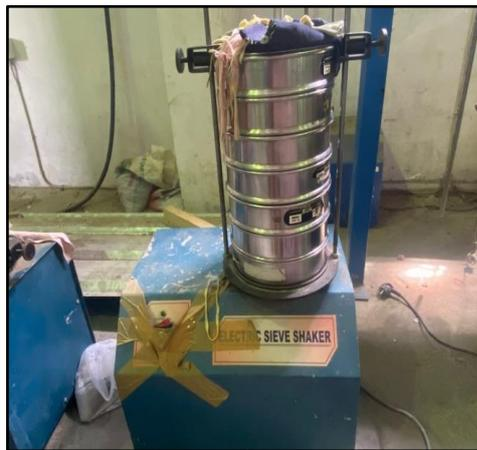
Gambar 3.8 Saringan dan mesin pengantar
