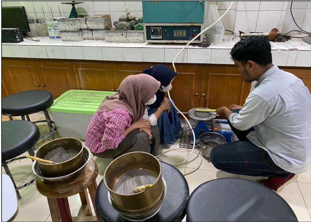
Gambar C.7 Pengukuran Slump Flow Test
