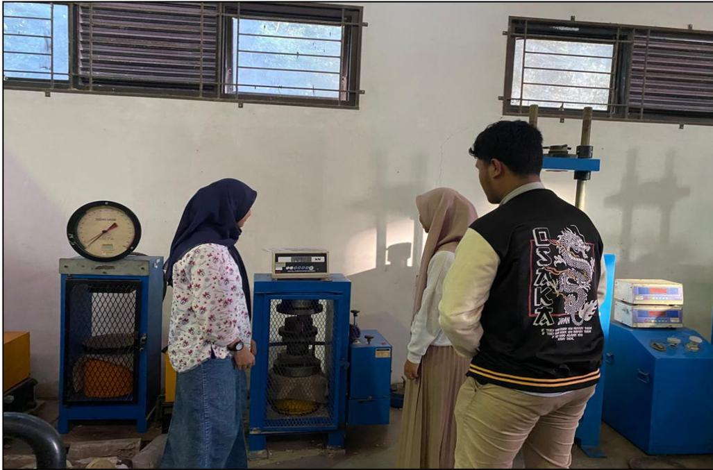
Gambar C.11 Pengujian Kuat Tekan Mortar
