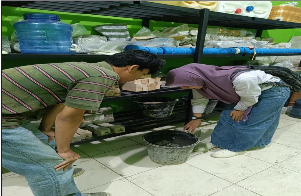
Gambar C.9 Perawatan Benda Uji
