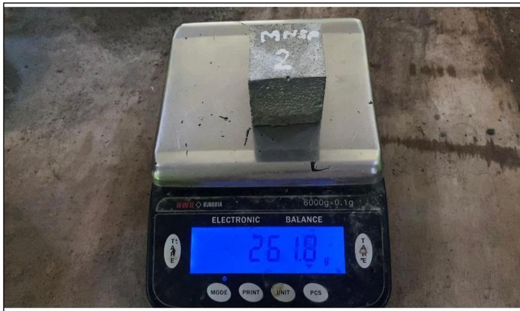
Gambar C.10 Penimbangan Benda Uji Kubus
