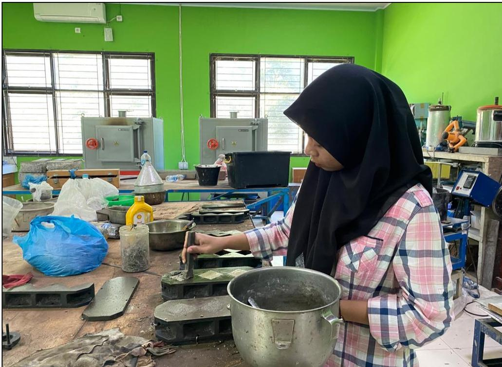
Gambar C.8 Memasukan Benda Uji Ke Dalam Bekisting
