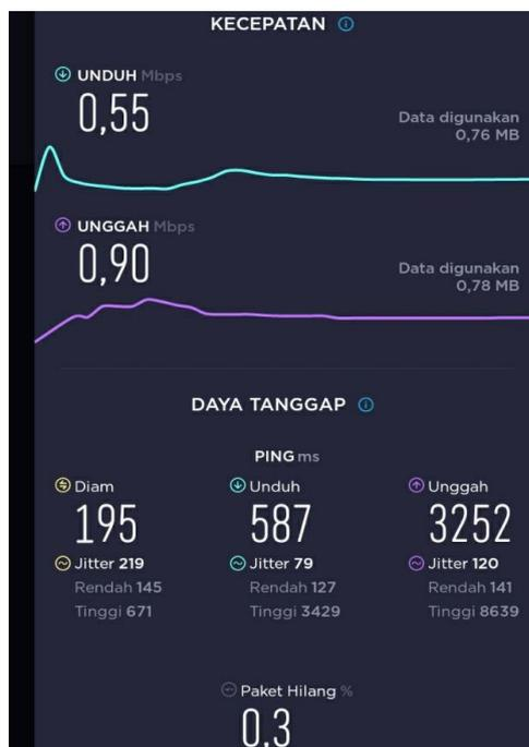
Gambar 4.27 Pengujian ke lima menggunakan aplikasi *Speedtest*
