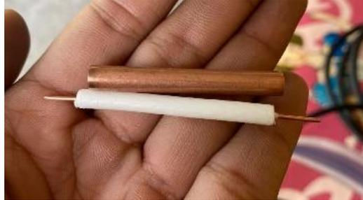
Gambar 4.10 Potongan pipa kapiler AC dan kabel Coaxial
