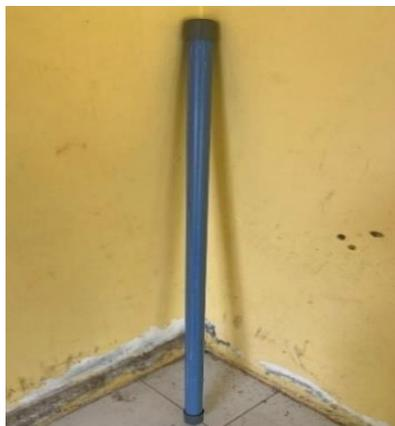
Gambar 4.15 Pipa Paralon yang sudah dimasukkan rangkaian element
