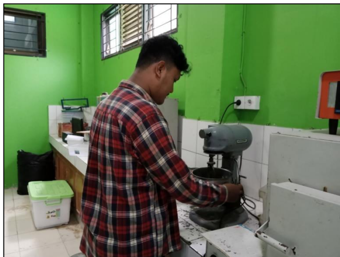
Gambar C.5 Pengadukan Material Penyusun Mortar
