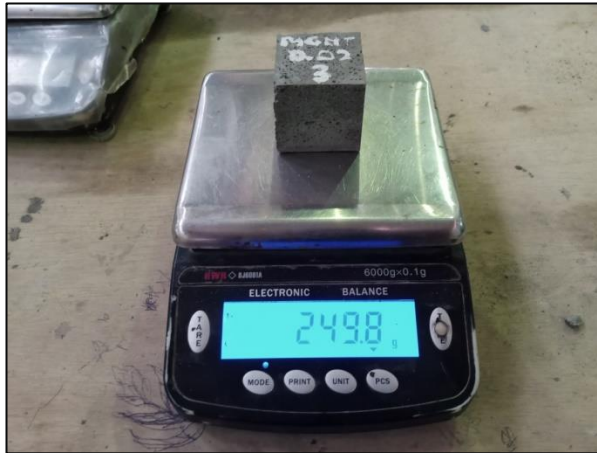
Gambar C.9 Penimbangan Benda Uji Kering Permukaan
