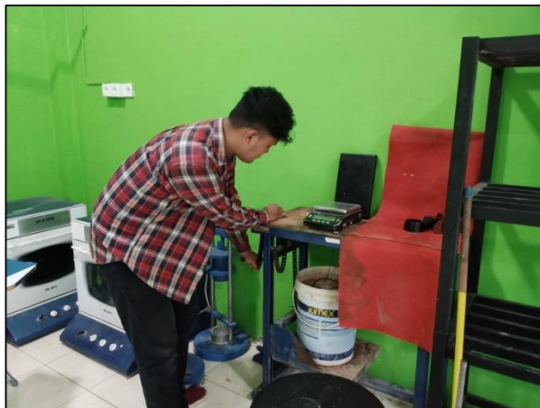
Gambar C.10 Penimbangan Benda Uji di Dalam Air
