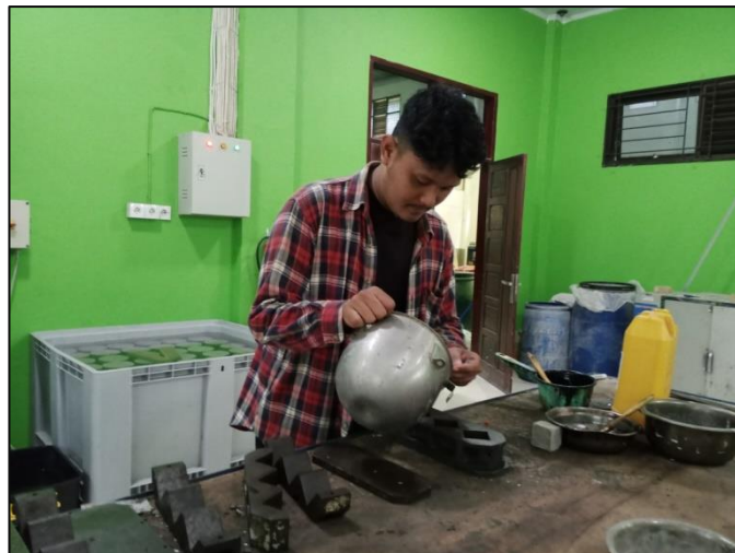
Gambar C.7 Pencetakan Mortar ke Bekisting Kubus
