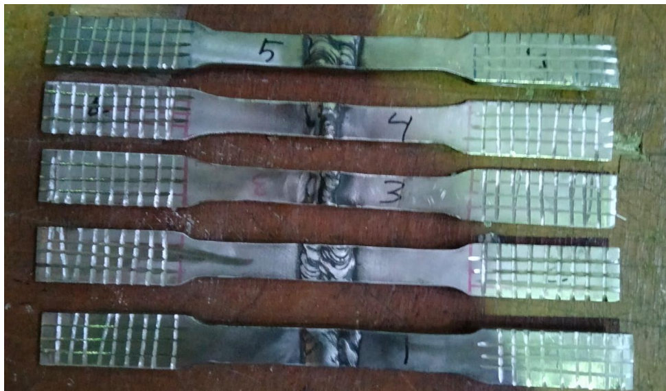
Gambar 4. 3 Hasil Pengelasan aliran gas pelindung 18 Liter/menit
