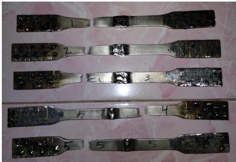
Gambar 4. 4 Patahan setelah dilakukan uji tarik aliran gas 8 Liter/menit
