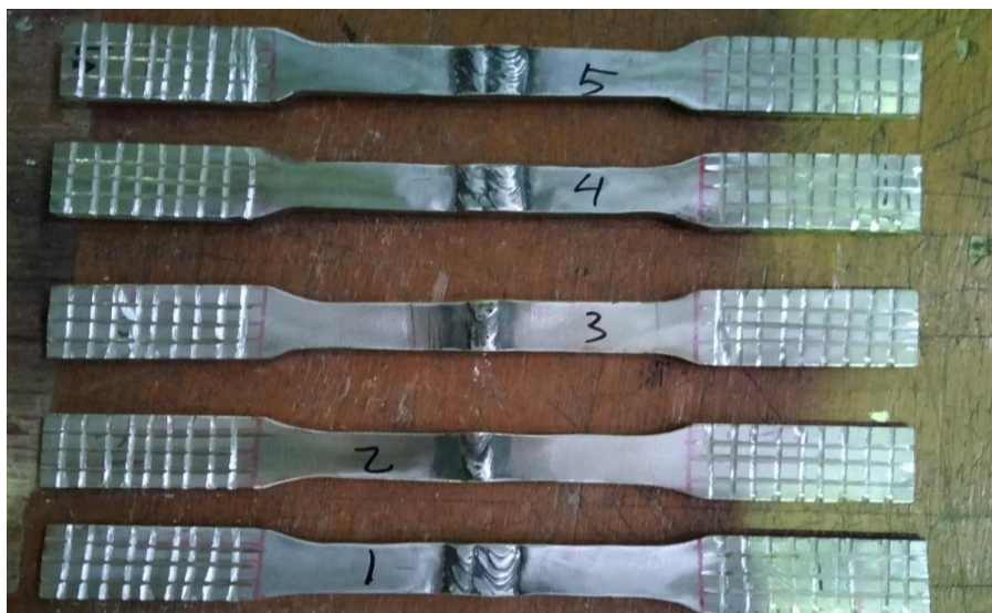
Gambar 4.1 Hasil Pengelasan aliran gas pelindung 8 Liter/menit
