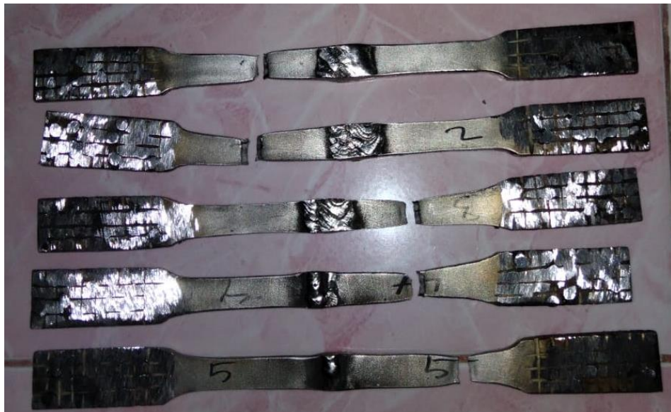
Gambar 4.5 Patahan setelah dilakukan uji tarik aliran gas 13 Liter/menit
