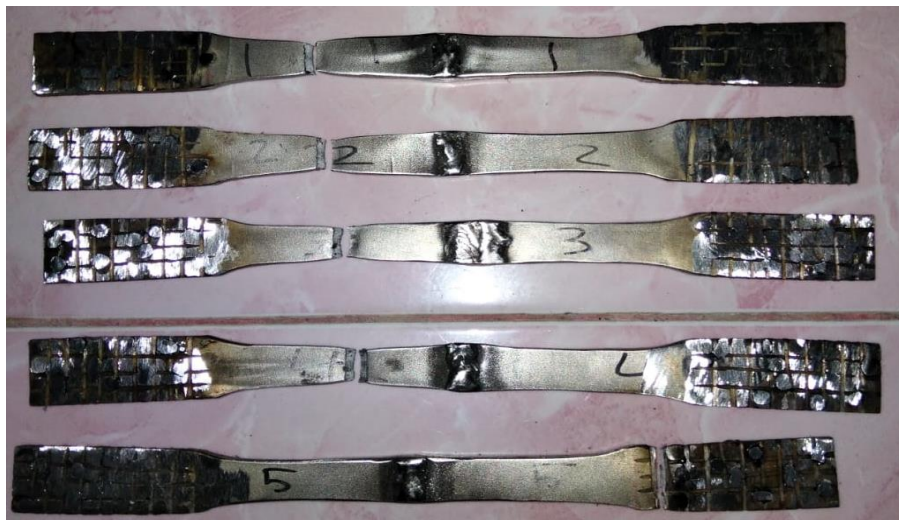
Gambar 4. 6 Patahan setelah dilakukan uji tarik aliran gas 18 Liter/menit
