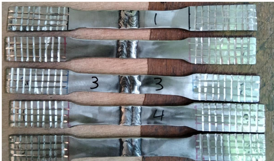
Gambar 4.2 Hasil Pengelasan aliran gas pelindung 13 Liter/menit
