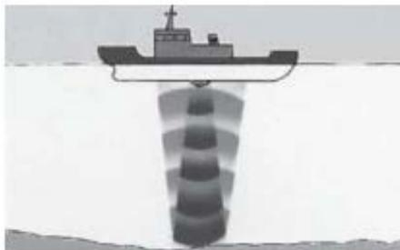
Gambar 2. 2 Sonar untuk mengukur kedalaman laut
