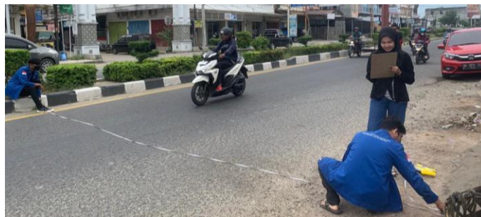
Gambar C. 10 Pengukuran geometrik jalan
