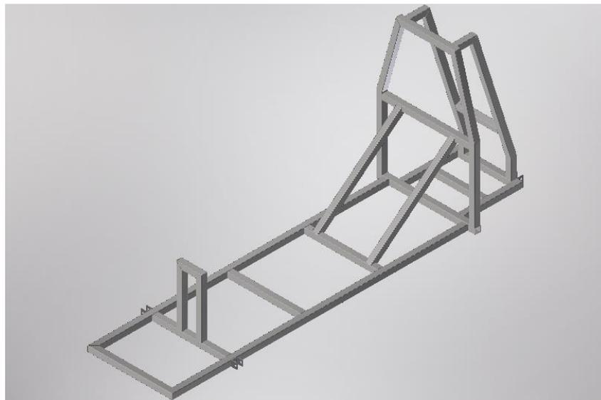
Gambar 4. 1 Desain *chassis* Mobil Listrik
