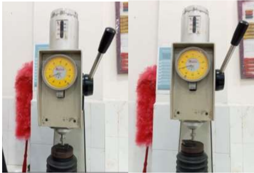
Dokumentasi 5. Hasil Uji Kekerasan Rockwell
