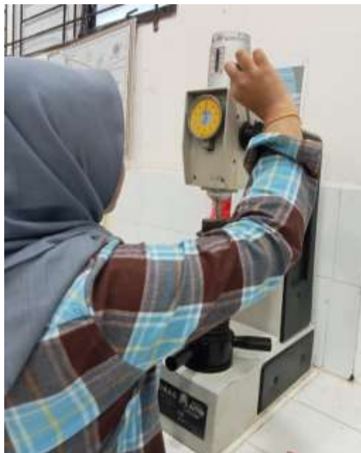
Dokumentasi 4. Pengujian Hardness Test (Rockwell C)
