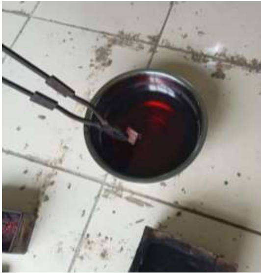
Dokumentasi 3. Proses Quenching Dengan Media Oli
