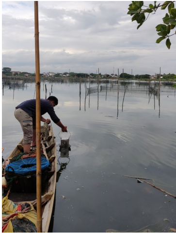
Proses Pengerokan Pengambilan Sampel Menggunakan Ekmen Grab
