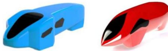
Gambar 2. 3 Desain *body* proto diesel I dan II
