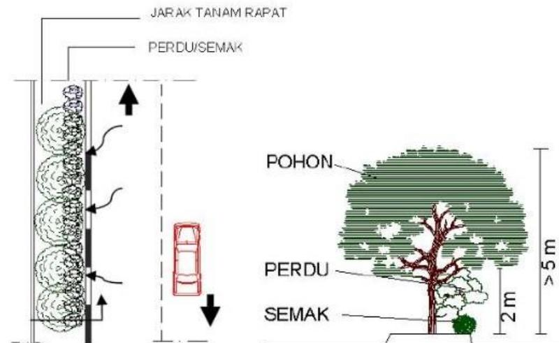
Gambar 2.3 Pohon Sebagai Pengontrol Polusi (Permenpu No 05/PRT/M/2008)
