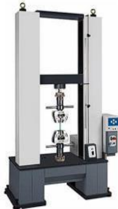
Gambar 2.5 Mesin Uji Tarik Sumber : PT. Geotek Saintifik Indonesia
